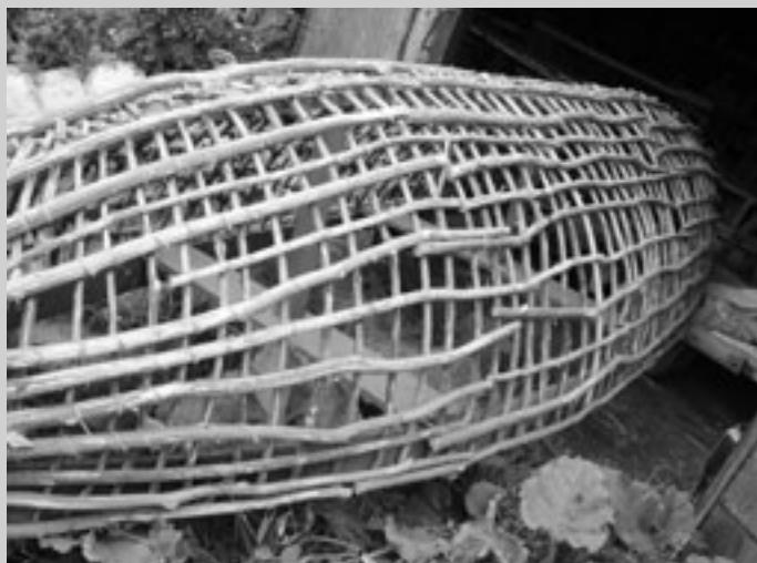
*Создание каркаса лодки из лозы*
